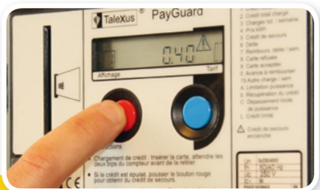
**10** Wenn der Strom abgeschaltet wird, können Sie den Notkredit aktivieren, indem Sie den roten Druckknopf drücken...
